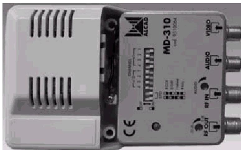
MODULATOR este un modulator de semnal A/V intr-un canal TV fie in banda I ( canale C2-C4 ), in banda III si S ( canale C5-C12 si S11-S20 ) sau in banda UIF ( canale C21-C69 ) avand posibilitatea programarii purtatoarei de sunet in majoritatea normelor ( BG , DK , I , L ) folosite in tarile europene. Intreaga schema este realizata in jurul circuitului integrat TDA-6060 care contine toate blocurile necesare modularii inclusiv un oscilator PLL comandat pe bus I2L. Aparatul este prevazut cu doua
